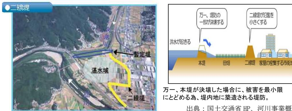
図 3.3.20 二線堤による氾濫防御のイメージ
