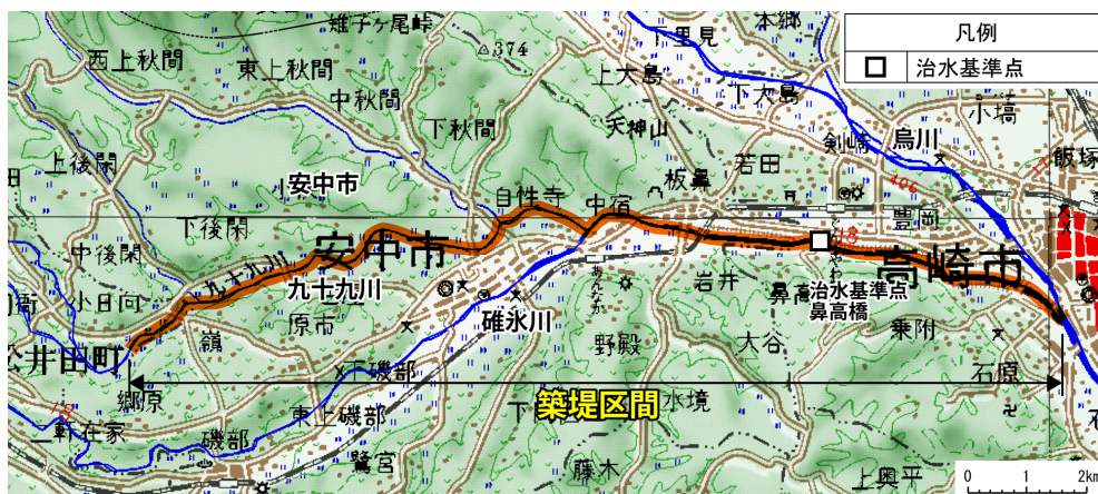
図 4.2.14 碓氷川流域における築堤区間（ダム下流）
