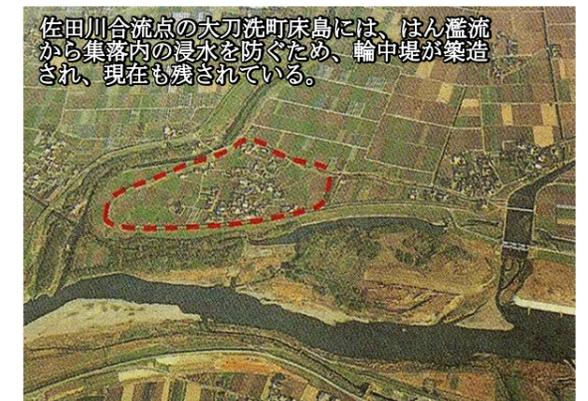
写真 1-5 佐田川合流点の輪中堤(大刀洗町)
