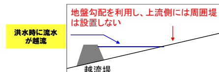
霞堤縦断面図イメージ
