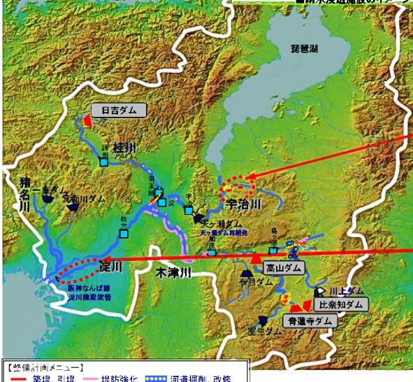
淀川は3.8km、大戸川は7.5kmにわたるH.W.Lを超過するため、雨水貯留施設、雨水浸透施設により流域からの流出を抑制するとともに、河道に流れ込む流量を低減させるため4つの既設ダムの利水容量買い上げにより洪水流量を調節し、淀川本川で約100m<sup>3</sup>/s増、大戸川で約280m<sup>3</sup>/s増となるよう河道を掘削する。
