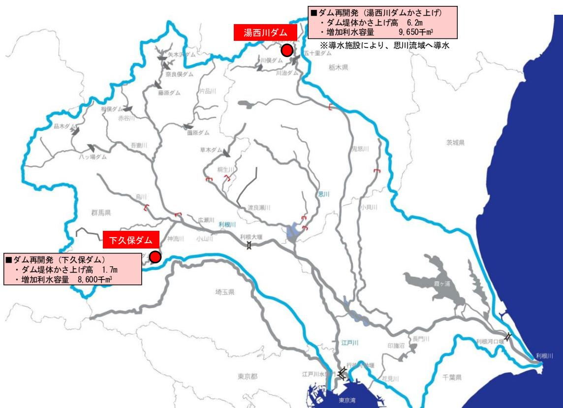
図 4.4-24 【ケース 1-1】ダム再開発による流水の正常な機能の維持対策案
