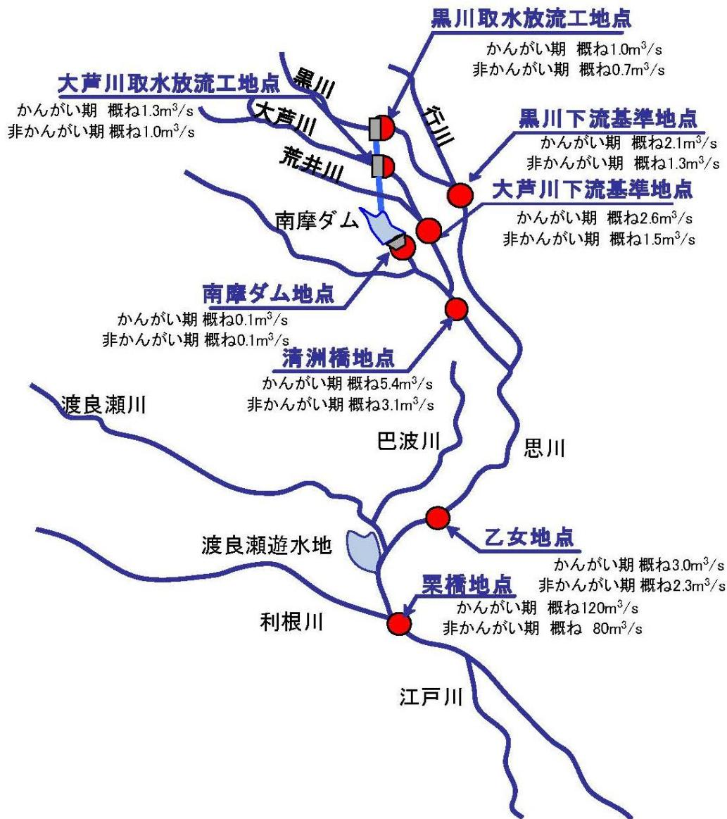
図 4.4-1 利水（流水の正常な機能の維持）基準地点模式図
