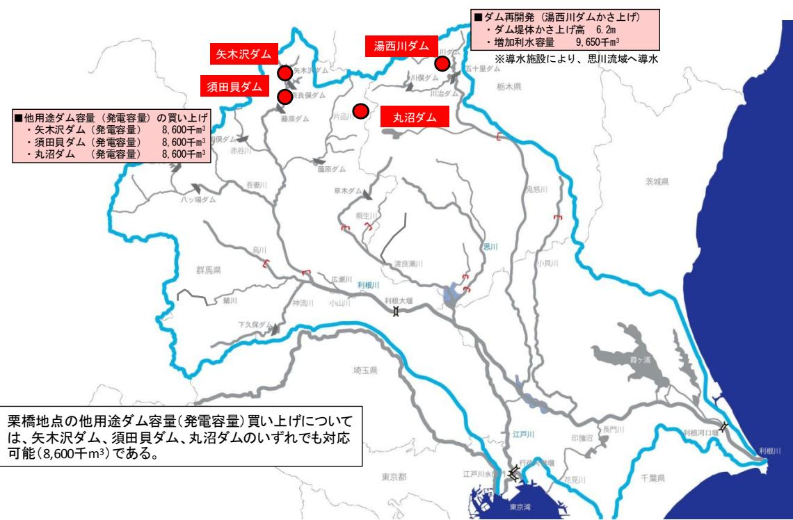
図 4.4-26 【ケース 3】他用途ダム容量（発電容量）買い上げによる流水の正常な機能の維持対策案
