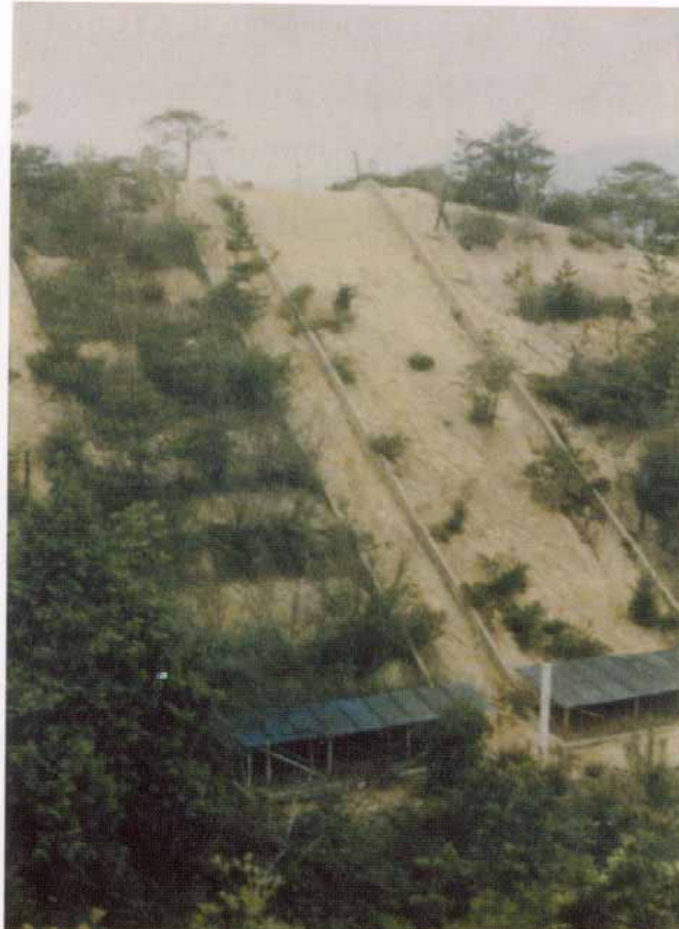
図 3-12 裸地と植栽地の水と土砂の流出 を調べる斜面ライシメータ
