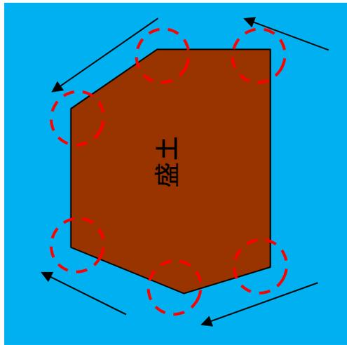
【3.5 浸透によるすべり破壊】
