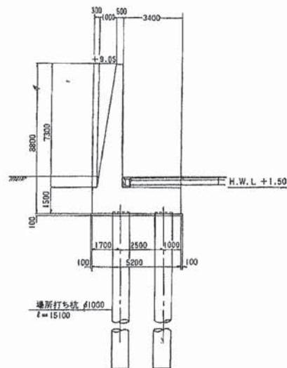
図 3.4.2.2 杭基礎を用いたL型式胸壁の例
