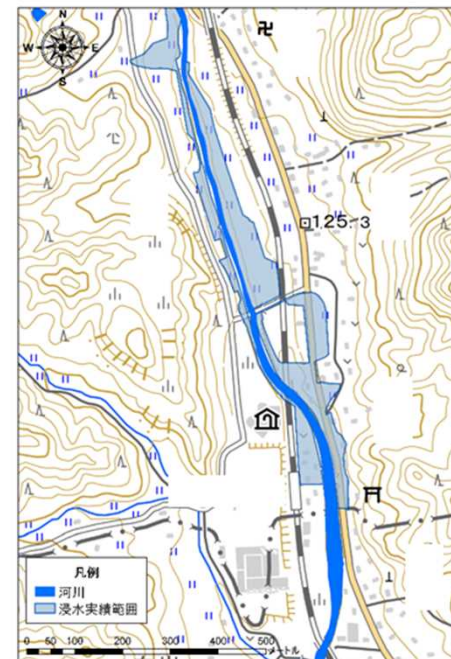
モデル検討河川の土砂洪水氾濫実績と浸水想定図試算結果の比較例
