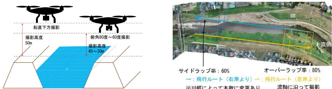
図.技 2-3 UAV 写真測量の計測方法
