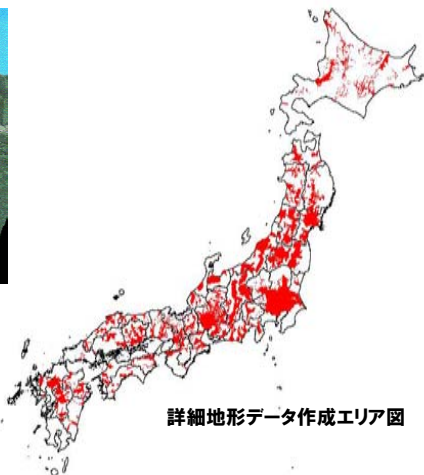
新たに作成する地形データ：標高誤差30cm程度 出典：『図解 航空レーザ計測』(財)日本測量調査技術協会
