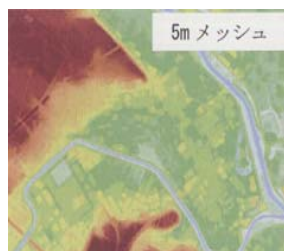
新たに作成する地形データ：標高誤差30cm程度 出典：『図解 航空レーザ計測』(財)日本測量調査技術協会
