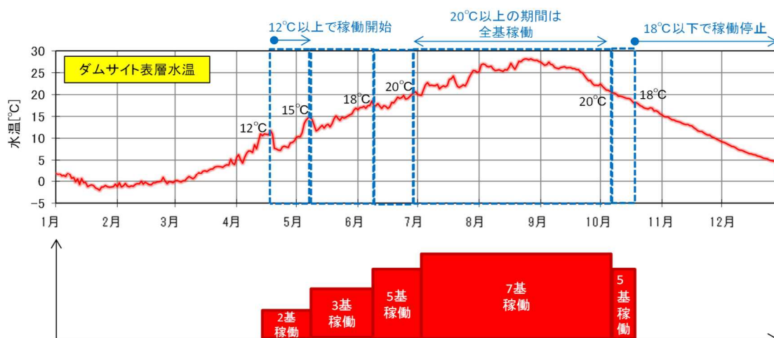
図 5.33 三春ダムにおける気泡式循環施設の運用ルールの設定例
