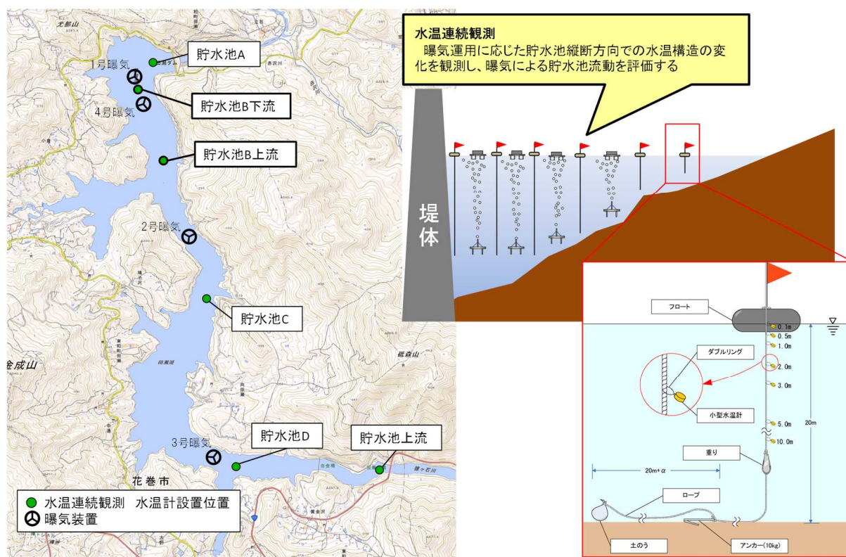
図 5.38 田瀬ダムにおける水温連続観測事例 水温計設置位置と設置方法
