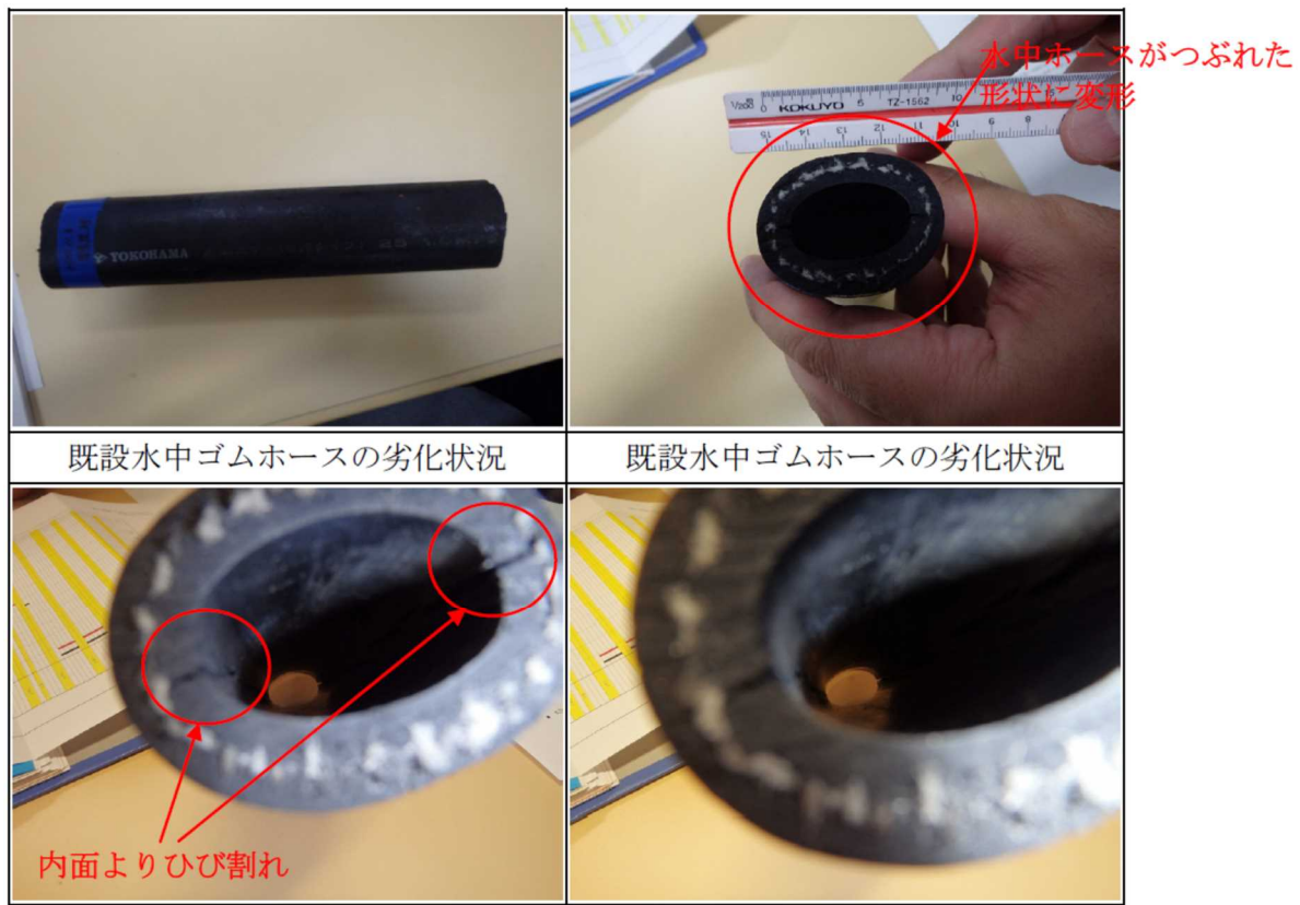
図 3.16 水圧による送水管の内部からの損傷事例
