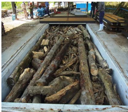
炭焼き釜へ流木投入状況
