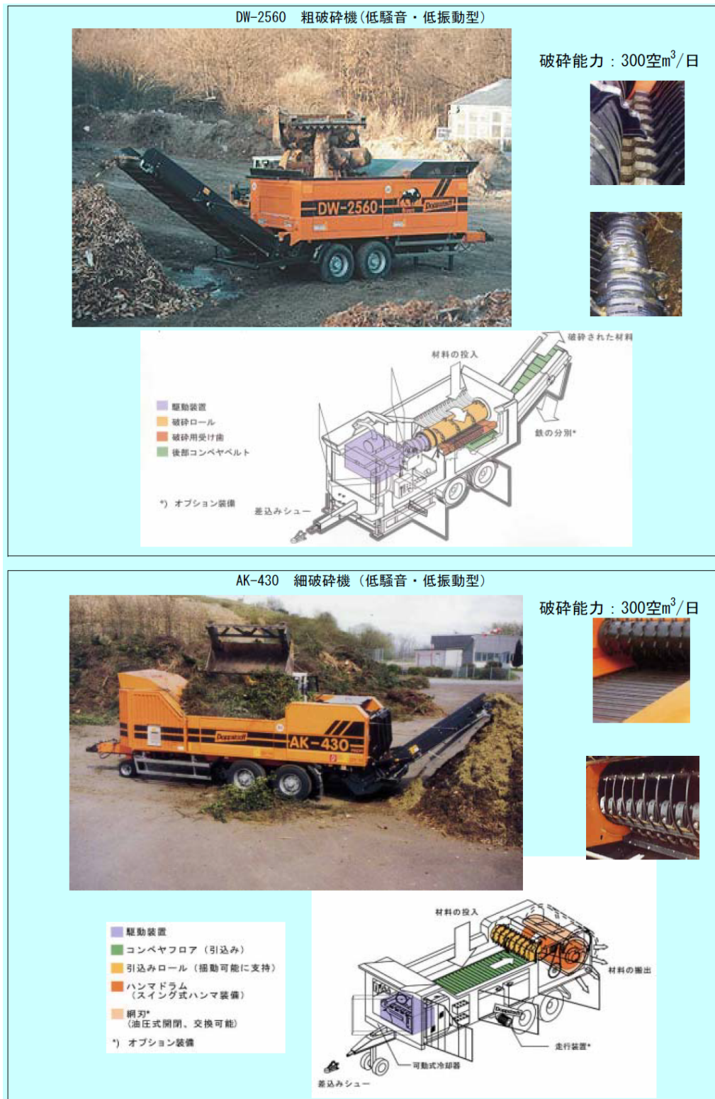
図 1.9 使用された破碎机（上段：粗破碎机 下段：細破碎机）
