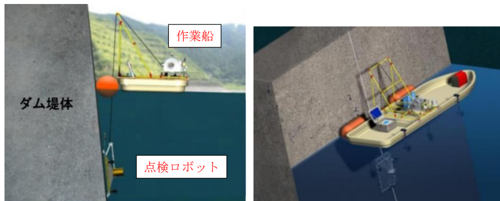
図 3.1.1 懸垂ロボット（水中機単体）概要図（例）
