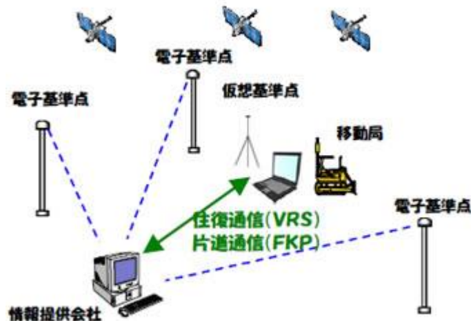
図22-3-8 ネットワーク型 RTK 方式概念図
