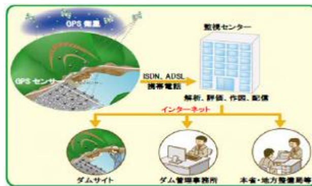
図22-3-9 GNSS ダム変形計測システム概念図
