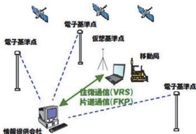
図22-3-8 ネットワーク型 RTK 方式概念図
