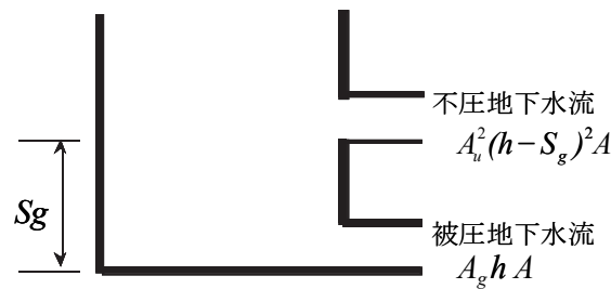
図3-2-5 各小区画の地下水モデルの構造
