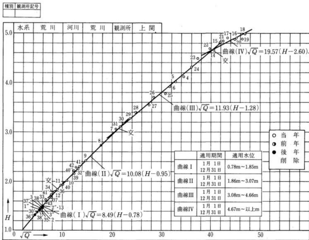
図 2-5-4 観測水位流量図 (H- $\sqrt{Q}$  図)
