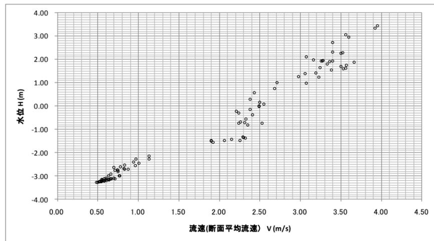
図 2-5-6 水位流速関係図（H-V図）の例
