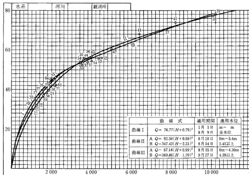
図 2-5-3 観測水位流量図 (H-Q 図)
