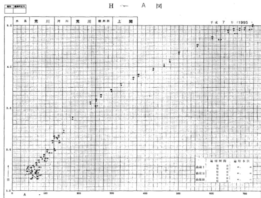
図 2-5-5 水位断面積関係図（H-A図）の例
