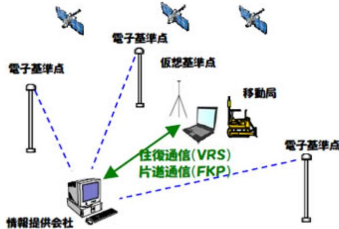
図22-3-8 ネットワーク型 RTK 方式概念図
