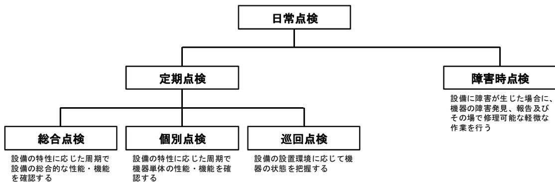
図 2-4 電気通信設備の日常点検の構成
