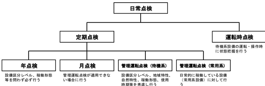
図 2-3 機械設備の日常点検の構成
