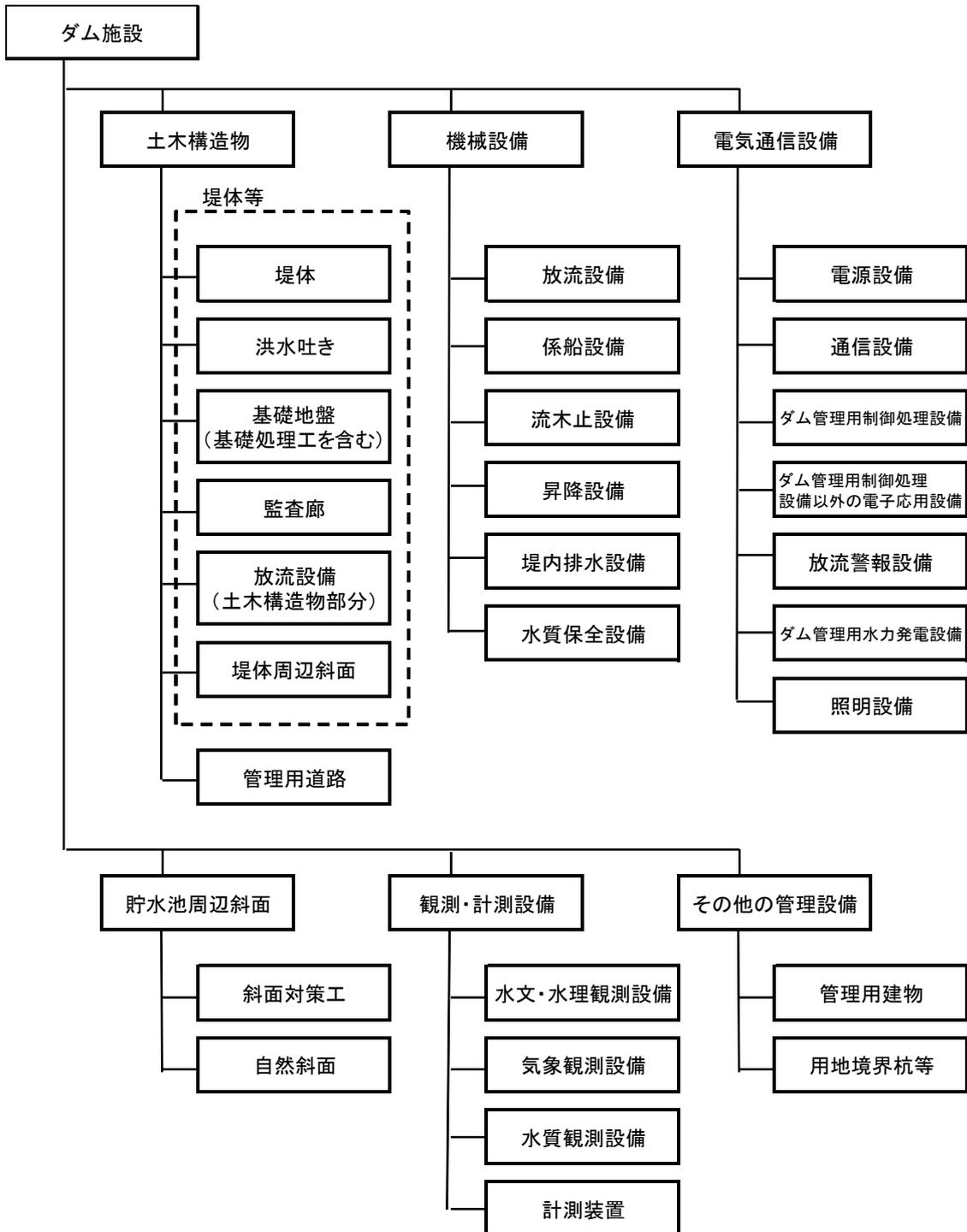
図1-1 ダム施設の一般的な構成
