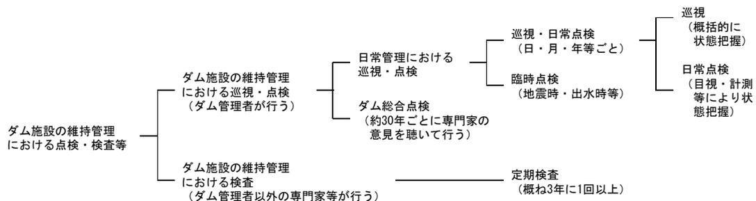
図2-1 ダム施設の維持管理における点検・検査等の構成
