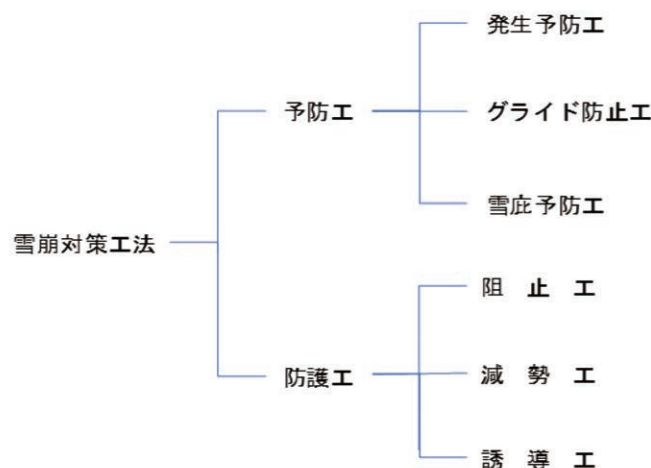
図 3-11 雪崩対策工法の分類
