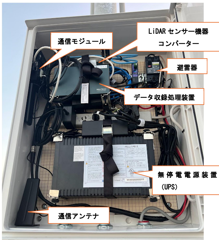
写真-3.1 検証時に用いた収納ボックスへの機器の収納状況
