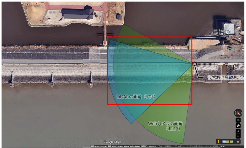
図-2.1 LiDAR センサー機器による観測画角の例
