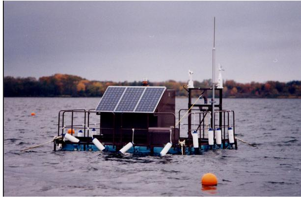
写真 2.2.1 水温塩分センサー(左)と青潮観測装置(右)
