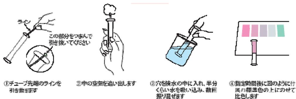
図 2.2.27 パックテストによる水質測定方法
