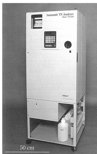
図 2.2.24 現地据付型水質測定機器の一例（全窒素自動分析装置）
