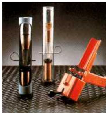
写真 2.2.2 C T Dと採水器 (左) とX C T Dとハンドランチャー (右)
