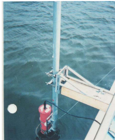
写真 6.2.6 観測船に固定した ADCP 〔センサー部が水面から 20～30cm 程度沈むように観測船に固定する〕
