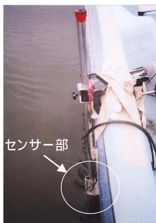
写真 6.2.4 観測船に取り付けた 魚群探知機 〔センサー部を 10cm 沈め、観測船に固定する。〕
