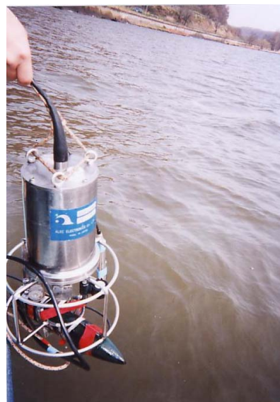
写真 6.2.8 船上から降ろしているクロロテック 〔観測船上からクロロテックを 1 分間に 1m の速度で下ろす。〕
