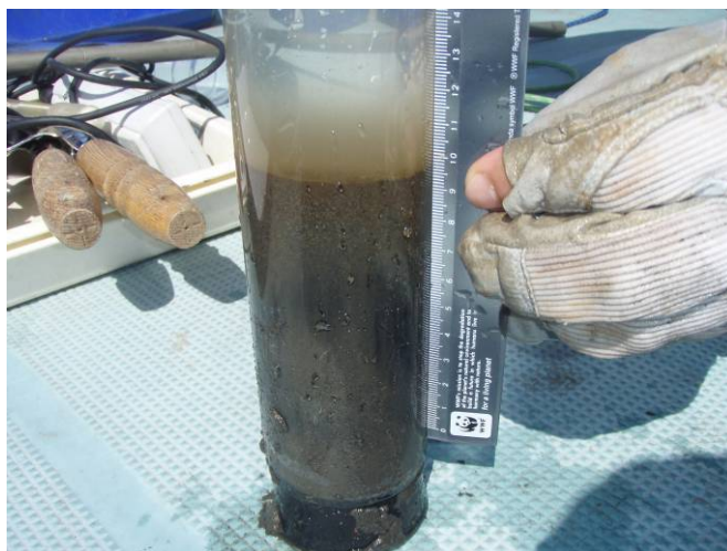
写真 酸化層が存在すると判断できるサンプルの例（H20 小川原湖 B 地点）
