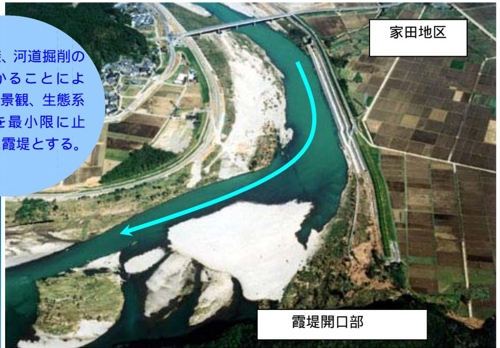
引堤の回避、河道掘削の低減をはかることによって、田園景観、生態系への影響を最小限に止めるために霞堤とする。
