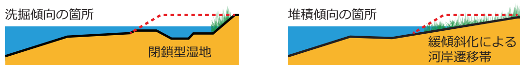
図 土砂堆積傾向に応じた改良方法
