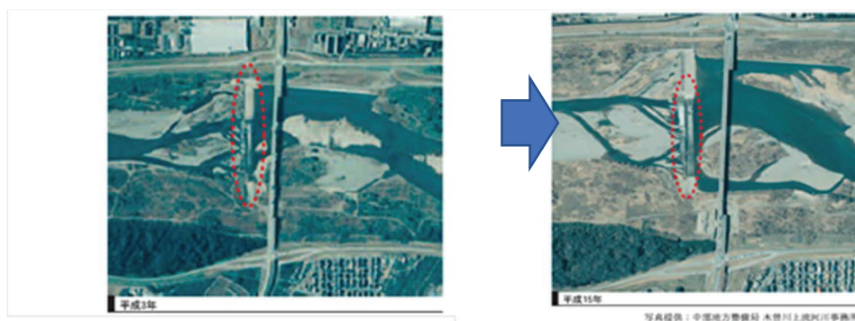
図-3 滲筋の変化の例 滲筋の変化により、床固工（円内）上下流の砂州形状が変動している。
