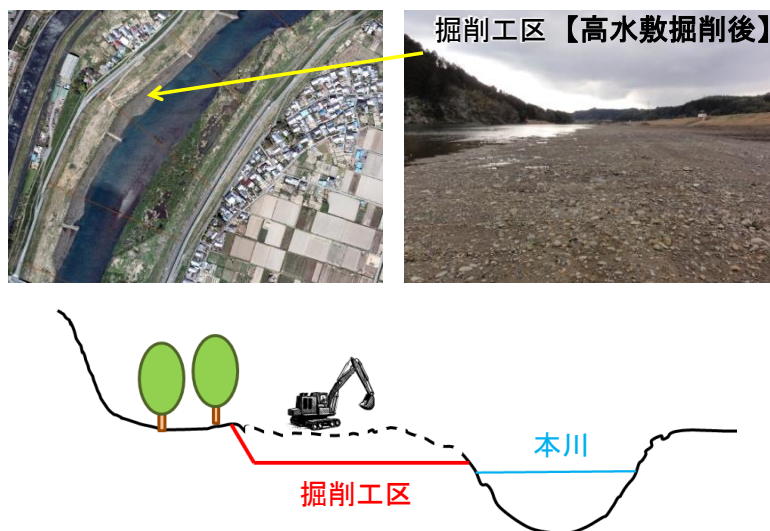
図 1 河道掘削（高水敷掘削）のイメージ
