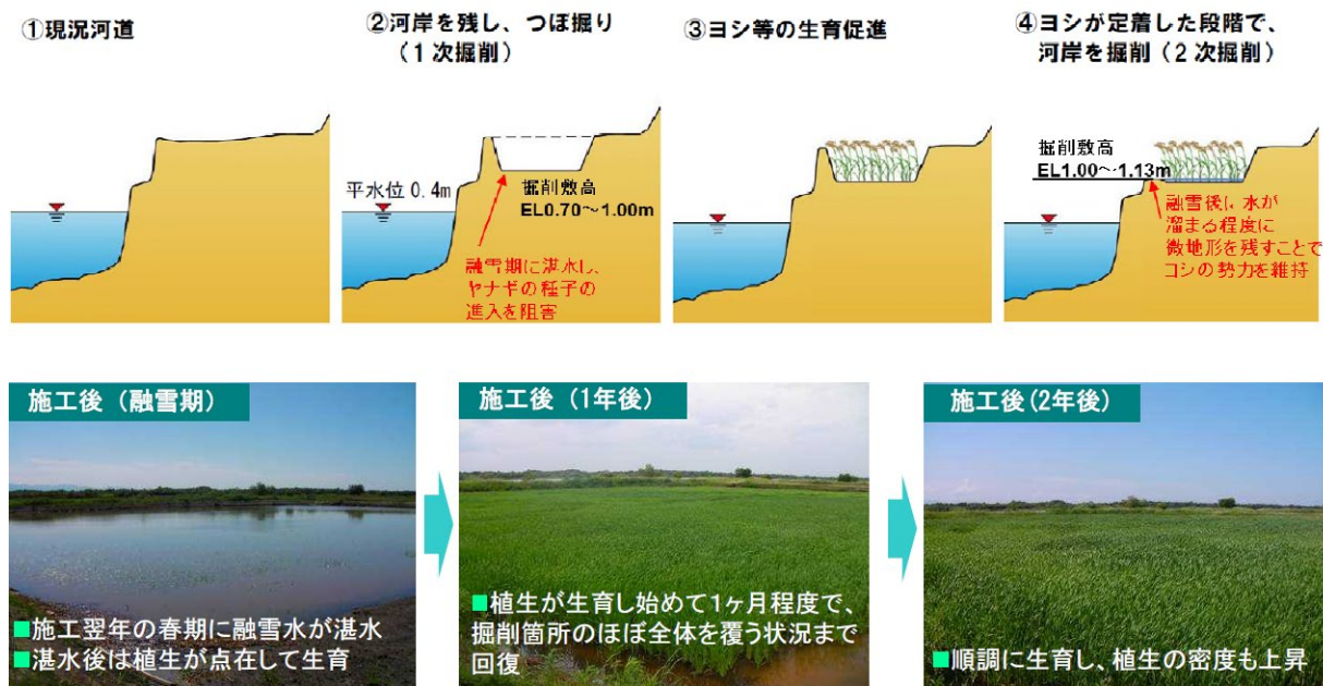
図 16 石狩川における河道掘削の模式図と施工後の経過写真 27)
