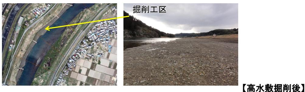
図 1 河道掘削（高水敷掘削）のイメージ（長良川セグメント1 区間）
