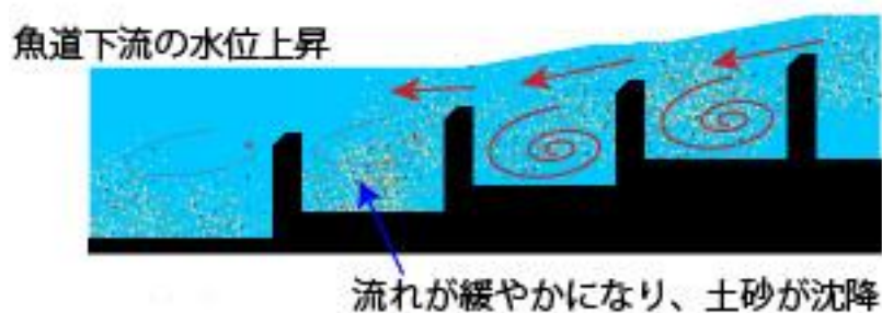
図-7 魚道下流側のせき上げによる魚道下流側の堆砂
