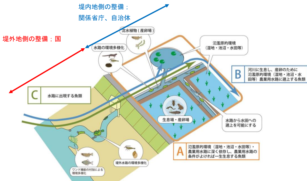
図一9 河川とその周辺の横断的連続性の再生の概念図 1)
