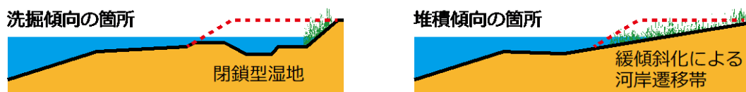
図 土砂堆積傾向に応じた改良方法
