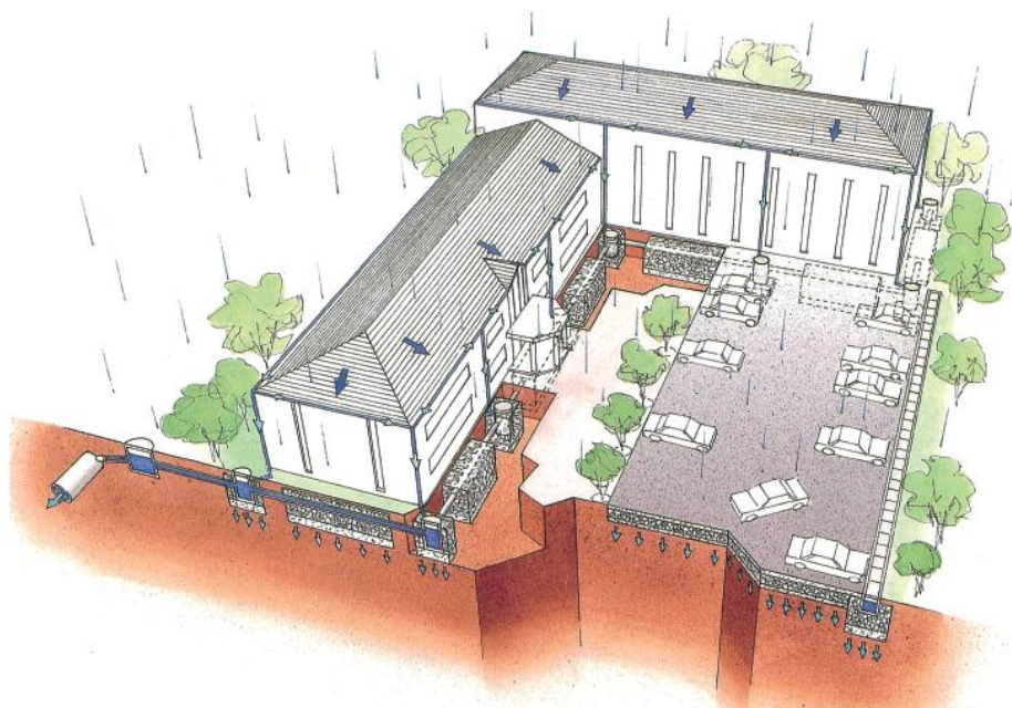
図 1-6 開発エリアにおける雨水浸透施設の設置イメージ (出典：増補改訂 雨水浸透施設設置技術指針(案) 調査・計画編)
