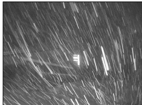
図 3-3 補助光とカメラの光軸が一致することにより生じるハレーション
