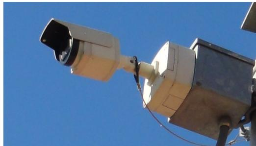
図 3-2 カメラカバーの設置例
