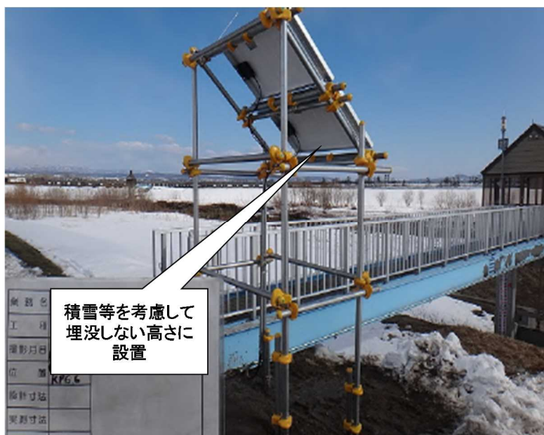
写真 3-7 寒冷地での水位計設置事例
