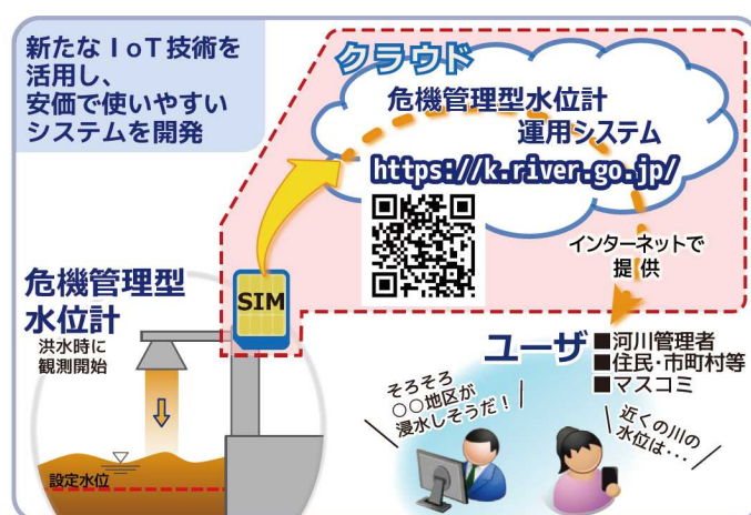
図 4-4 危機管理型水位計運用システムの概要
