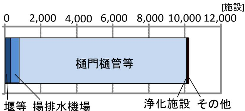
図-1 直轄河川における河川構造物の設置数
