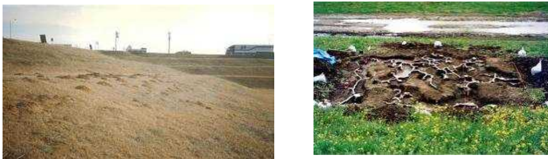
図 - 4 モグラ塚の例(左) 及び 調査で可視化された巣穴の実態(石膏部 分)(右)
