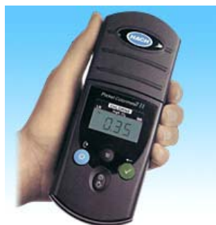
図 7.4 ポケット水質計の例
