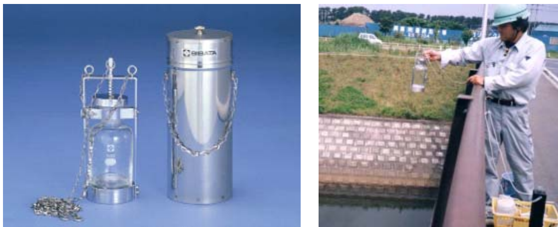
図 8.18 ハイポート採水器による採水
