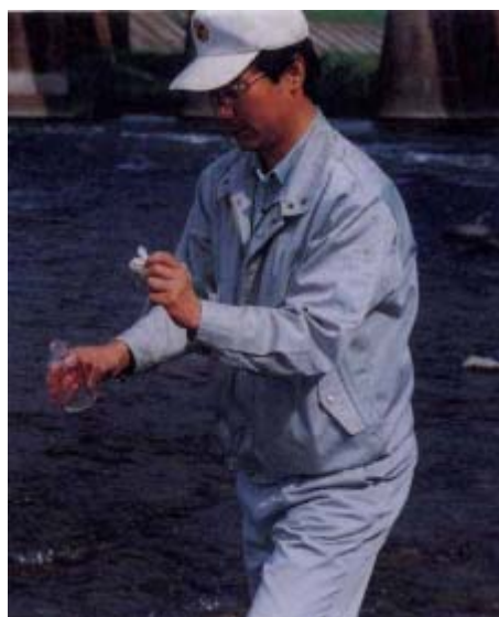
図 8.25 滅菌瓶による採水
