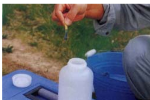
図 8.24 金属類の酸又はアルカリ固定
