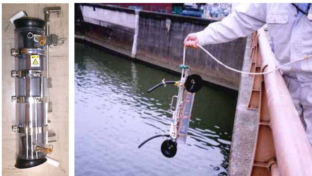
図 8.17 バントーン採水器による採水
