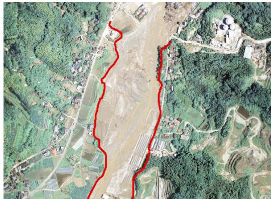
図-1 被災後の航空写真に基づく浸水範囲の判読イメージ （航空写真と照らし合わせながら氾濫範囲境界をなぞる（赤線））
