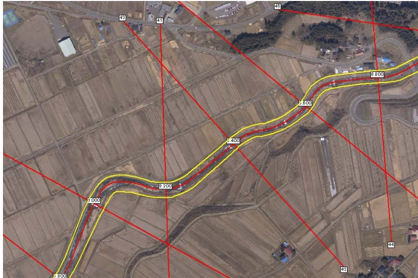
水位計算範囲および横断測線設定画面（中小河川治水安全度評価システム）
