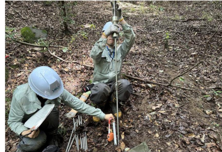
図4.4 簡易貫入試験実施状況
