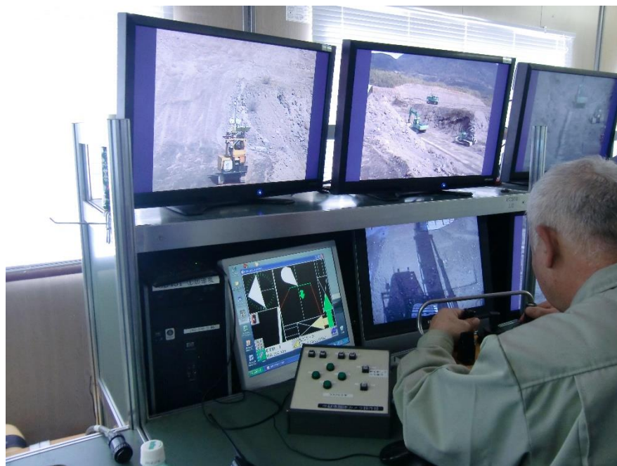
写真-1.8 マシンガイダンスシステムを使用した運転
