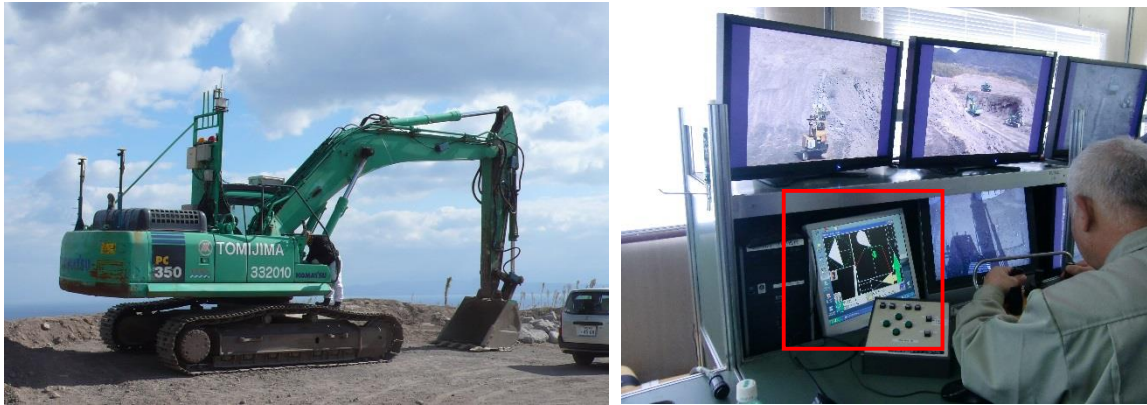
写真-3.19 マシンガイダンスシステム（左：機械 右：操作状況）
