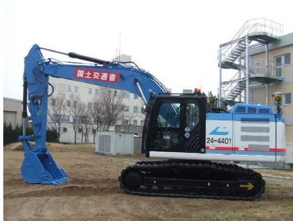
図-5.3 分解組立型バックホウ（北陸地方整備局配置）の装備品
