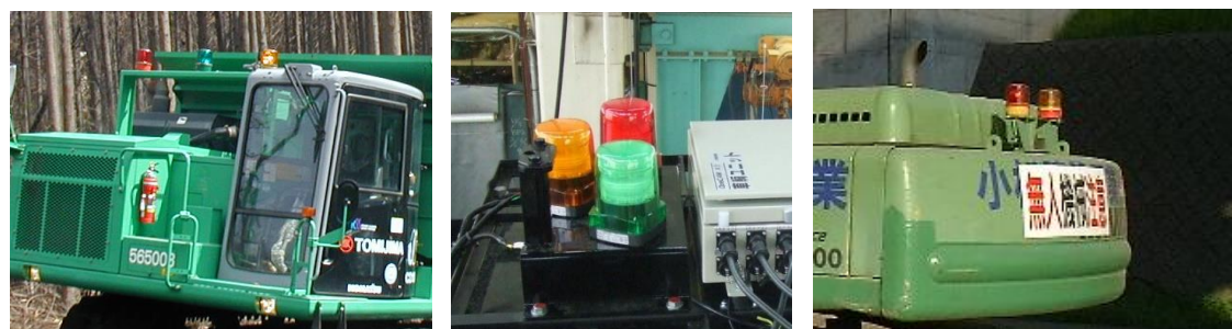
写真-3.9 遠隔操作式建設機械に設置される回転灯
