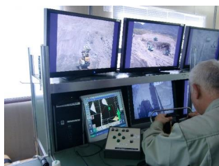
写真-2.3 マシンガイダンスシステム（左：機械 右：操作状況）
