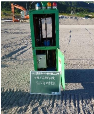
写真-7.3 簡易支持力測定（左）および平板載荷試験の遠隔システム 表-7.8 品質管理基準および規格値例（雲仙普賢岳 砂防えん堤工事）
