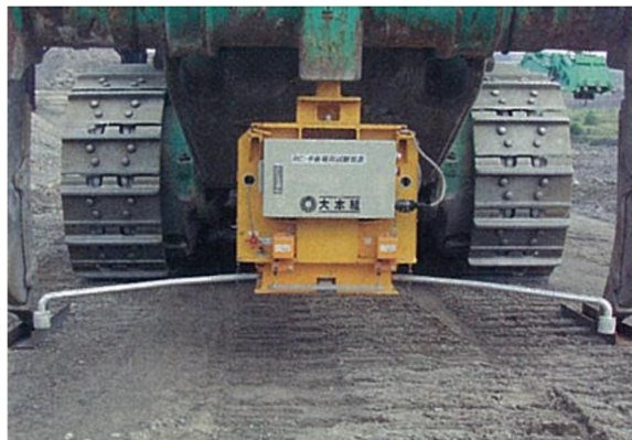
写真-7.3 簡易支持力測定（左）および平板載荷試験の遠隔システム 表-7.8 品質管理基準および規格値例（雲仙普賢岳 砂防えん堤工事）
