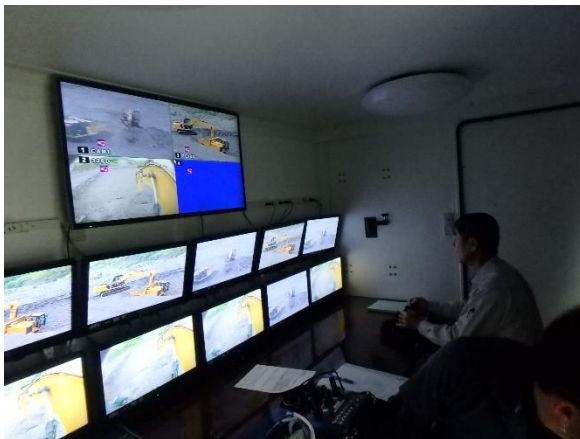
写真-4.2 地元企業による無人化除石試験施工（映像視認）
