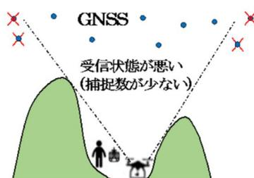
図 II-10 GNSS の受信状況の悪い場所
