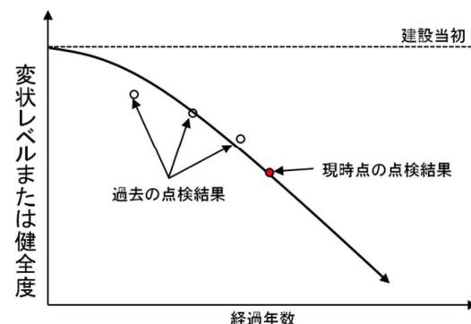
図-3.3 劣化予測の精度向上のイメージ
