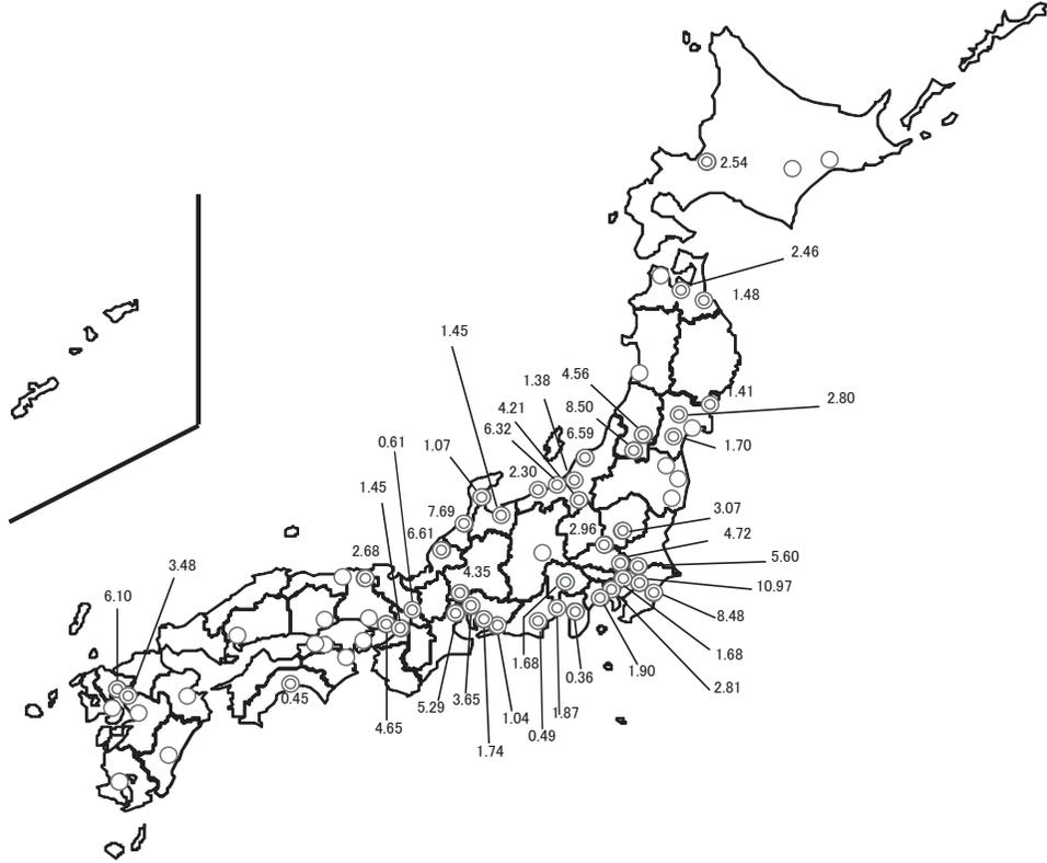
◎ 直近5年間（平成28年度～令和2年度）に地盤沈下測定のための水準測量が1回以上実施された地域（42地域）
