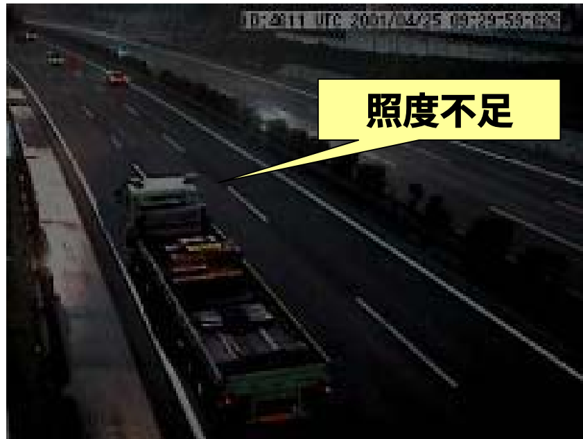
薄暮、夜間のコントラスト不足事例
