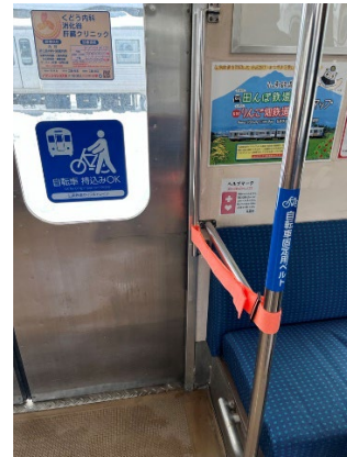
写真:固定ベルトの車内への常設(青森県 弘南鉄道)
