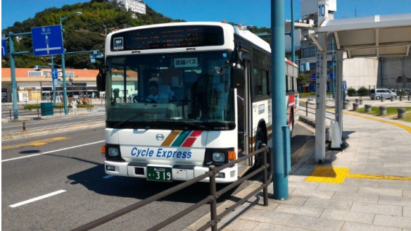
写真:自転車搭載高速バス(広島県・愛媛県 しまなみサイクルエクスプレス(おのみちバス)2020 年廃止) ※搭載時は前輪を外すことが必要。車体左側座席が自転車搭載スペースとなっていた
