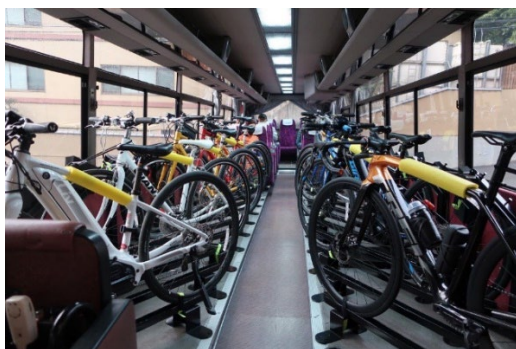
写真:座席を撤去した貸切用サイクルバス(西鉄観光バス)
