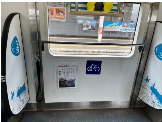
写真:車内のデッドスペースを自転車搭載スペースとしている例(島根県 一畑電車)
