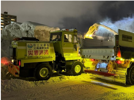
支援機械による排雪作業(札幌市)
