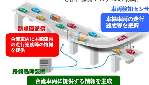
▲インフラ側からの情報提供事例 (高速道路の合流部において、本線の交通状況をセンサで検知し、自動運転車に情報提供)
