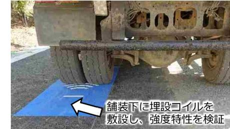
実験施設での強度検証
