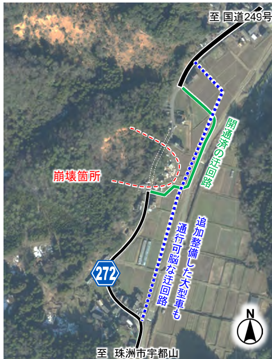
大型車が通行可能な迂回路を啓開作業状況
